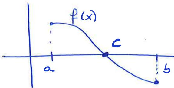
Aplicación de este teorema: Método de la bisección para resolver numéricamente una ecuación no lineal de la forma  $f(x) = 0$ .
